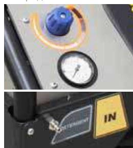
Регулятор моющего средства с соединителем в передней части
