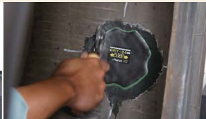
15 Используя ролик раскатку, тщательно раскатайте пластырь, двигаясь от центра к краям. При ремонте бескамерной шины, нанесите герметик бескамерного слоя по периметру пластыря.
