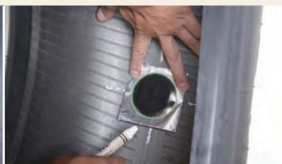
9 Приложите универсальную заплатку на повреждение. Повреждение должно быть по центру пластыря. Обведите мелом контур пластыря.
