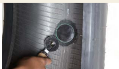
15 Используя ролик-раскатку, тщательно раскатайте заплатку. При ремонте бескамерной шины, нанесите герметик бескамерного слоя по периметру пластыря.
