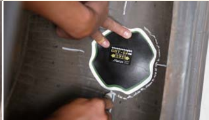
9 Приложите подобранный по таблице (стр. 6) диагональный пластырь на повреждение, чтобы стрелки указывали на борта шины. Повреждение должно быть по центру пластыря. Обведите мелом контур пластыря.
