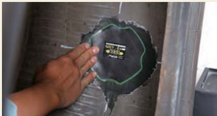
14 Удалите защитную пленку и прижмите центр пластыря к повреждению. Не прикасайтесь пальцами к адгезивному слою. Перед наложением пластыря убедитесь, что борта шины не напряжены!
