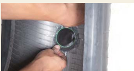
14 Удалите защитную пленку и прижмите центр заплатки к повреждению. Не прикасайтесь пальцами к адгезивному слою. Перед наложением заплатки убедитесь, что борта шины не напряжены!
