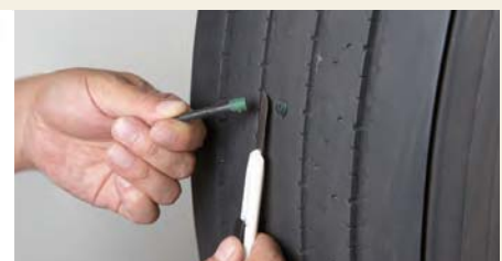
16 Отрежьте выступающую часть ножки грибка на 2-3 мм выше уровня поверхности шины с внешней стороны.
