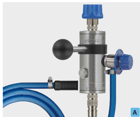
Муфта ST-45-250 никелир. латунь : штекер ST-45-250 нерж. сталь. Инжектор ST-167 с дозирующим вентилем ST-161, всасывающим шлангом 2.000 мм и всасыв. фильтром ST-31. Макс. 250 bar / 100 °C
