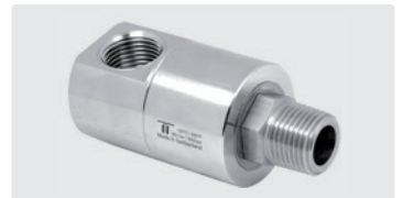
DGEI 90°. Корпус из никелированной латуни. 3 подшипника. Макс. 350 bar
