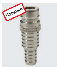
ST-45. Никелированная латунь. Ниппель с наконечником для шланга 13-19 мм. 25 bar / 90° C
