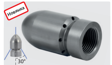
1" IG. Наружный \varnothing 48 мм. 8 отверстий сзади, с фронт. отверстием
