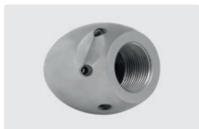
3/4" IG. 6x 75° +1x 0°. 30-100 л/мин. Для R Ø 120-250 мм. Наружный Ø 50 мм. Ⓢ 567 г.
