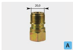
Штекер : IG. Оцинк. сталь. Макс. 250 bar / 150 °C
