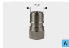
Штекер : IG. Закаленная нежр. сталь. Макс. 250 bar / 150 °C
