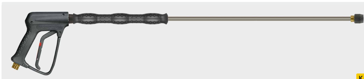
Профес. пистолет R+M EcoLine No. ONE с копьём 900 мм из оцинк. стали, изоляцией ST-28 Cool & Compact 300 мм и защитой форсунки без мундштука. Макс. 250 bar / 45 л/мин / 150 °C
