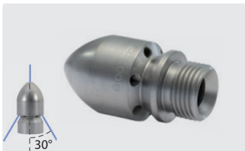
1/2" AG. AGR уплотнительный конус. Наружный \varnothing 30 мм. 6 отверстий сзади, с фронт. отверстием
