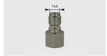
Штекер : IG. \varnothing 14,8 мм. Оцинк. сталь. Макс. 250 bar / 100 °C
