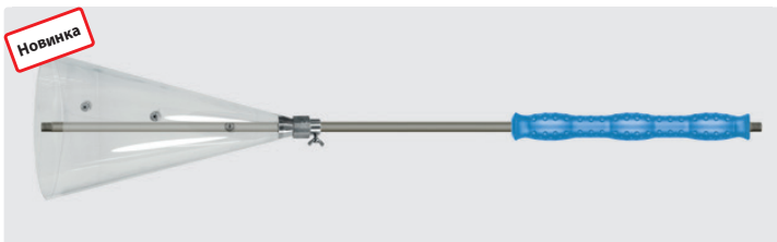
Копье с изоляцией ST-29 Cool &amp; Compact. Приятная эргономичная ручка. Закрытая наружная поверхность. С защитной воронкой от брызг. Регулируемая с помощью барашкового винта. Макс. 400 bar / 80 °C
