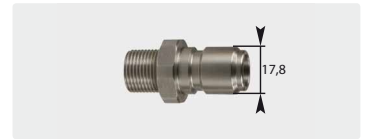
Штекер : AG. Нерж. сталь. 60° упл. конус. Макс. 250 bar / 150 °C
