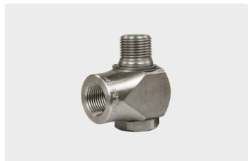
3/8" IG : 3/8" AG. DN 6. Макс. 400 bar / 30 об/мин / 90 °C
