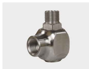
1/2" IG : 1/2" AG. DN 12. Макс. 300 bar / 30 об/мин / 90 °C
