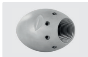
1" IG. 8x 75° +1x 0°. 100-250 л/мин. Для R Ø 150-300 мм. Наружный Ø 62 мм. Ⓢ 1.265 г.
