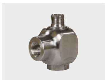
3/8" IG : 3/8" AG. DN 10. Макс. 400 bar / 30 об/мин / 90 °C
