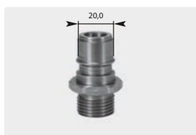
Штекер : AG. Закаленная нежр. сталь. Макс. 250 bar / 150 °C
