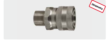
Муфта : AG. Нерж. сталь. 60° упл. конус. Макс. 250 bar / 150 °C
