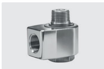
3/8" IG : 3/8" AG. DN 7. Макс. 275 bar / 30 об/мин / 120 °C
