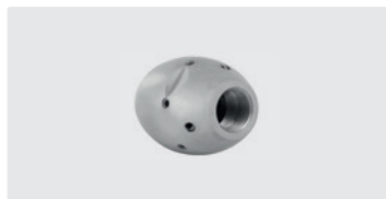
1/4" IG. 6x 75° 3x 30° +1x 0°. 25-70 л/мин. Для R Ø 75-150 мм. Наружный Ø 30 мм. Ⓢ 223 г.
