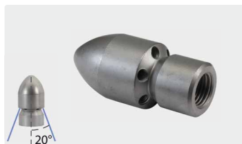
1/4" IG. Наружный \varnothing 25 мм. 6 отверстий сзади
