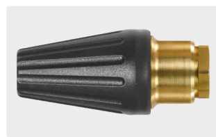
1/2" IG. Угол распыления 20°. 120 - 250 bar. Макс. 100 °C
