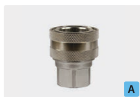
Муфта : IG. Никелир. латунь. Макс. 250 bar / 150 °C
