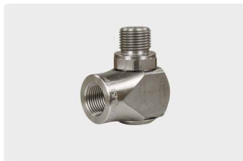
3/8" IG : 3/8" AG. DN 6. Макс. 400 bar / 30 об/мин / 90 °C
