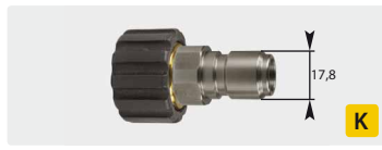
Штекер : IG. Нерж. сталь + латунь. Макс. 250 bar / 150 °C
