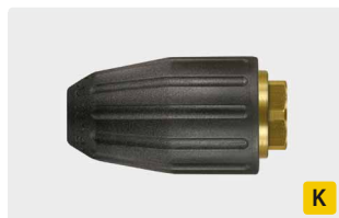
M18 IG. Угол распыления 20°. 200 - 350 bar. Макс. 100 °C
