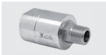
DGEI. Корпус из никелированной латуни. 3 подшипника. Макс. 350 bar
