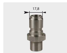
Штекер : AG. Нерж. сталь. 60° упл. конус. Макс. 250 bar / 150 °C
