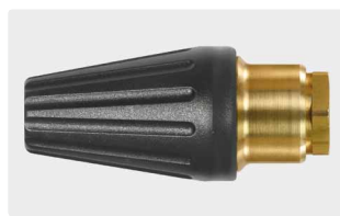
1/2" IG. Угол распыления 20°. 120 - 250 bar. Макс. 100 °C
