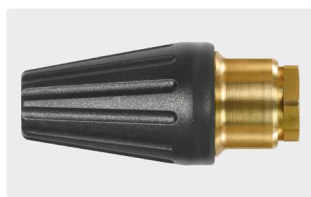
1/4" IG. Угол распыления 20°. 120 - 250 bar. Макс. 100 °C
