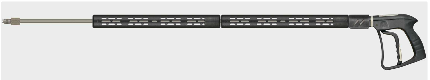
Профес. пистолет для пара Weer-исполнение с копьём из нерж. стали, изоляцией ST-9 380 мм и форсункой для пара низкого давления из нерж. стали. Макс. 20 bar / 200 °С
