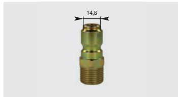
Штекер : AG. \varnothing 14,8 мм. Оцинк. сталь. Макс. 250 bar / 100 °C
