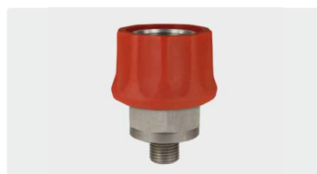
Муфта : AG. Нерж. сталь. Макс. 600 bar / 150 °C
