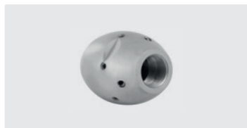
3/8" IG. 6x 75° 3x 30° +1x 0°. 30-100 л/мин. Для R Ø 100-200 мм. Наружный Ø 35 мм. Ⓢ 314 г.
