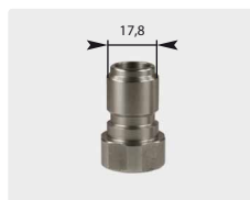
Штекер : IG. Нерж. сталь. Макс. 250 bar / 150 °C
