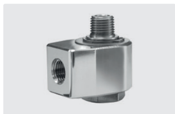
1/4" IG : 1/4" AG. DN 7. Макс. 275 bar / 30 об/мин / 120 °C
