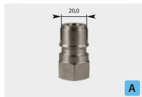
Штекер : IG. Нерж. сталь. Макс. 250 bar / 150 °C
