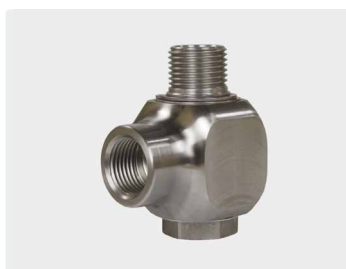
1/2" IG : 1/2" AG. DN 12. Макс. 300 bar / 30 об/мин / 90 °C
