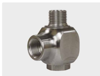
1/2" IG : 1/2" AG. DN 12. Макс. 300 bar / 30 об/мин / 90 °C
