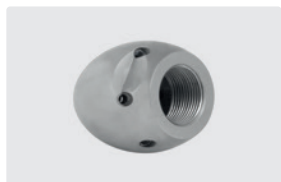
1/2" IG. 6x 75° +1x 0°. 30-100 л/мин. Для R Ø 100-200 мм. Наружный Ø 40 мм. Ⓢ 281 г.
