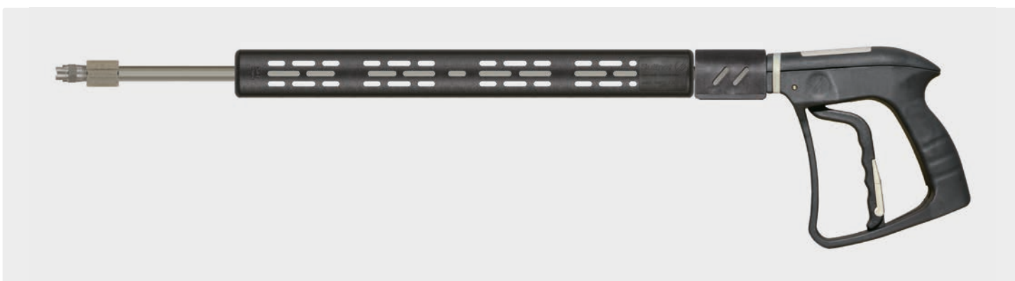
Профес. пистолет для пара ST-4000 с копьём из нерж. стали 500 мм, изоляцией ST-9 380 мм и форсунки для пара низкого давления из нерж. стали. Макс. 20 bar / 200 °C
