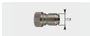
Штекер : IG. Нерж. сталь. Макс. 250 bar / 150 °C
