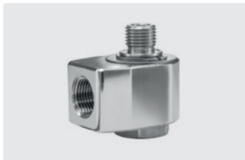
3/8" IG : 1/4" AG. DN 7. Макс. 150 bar / 30 об/мин / 90 °C
